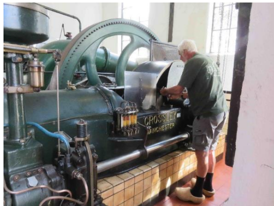
Afscherming van de kruk en drijfstang met plexiglas
