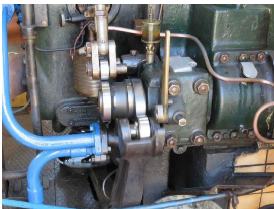
Klepbewegingsinrichting niet-afgeschermdde situatie
