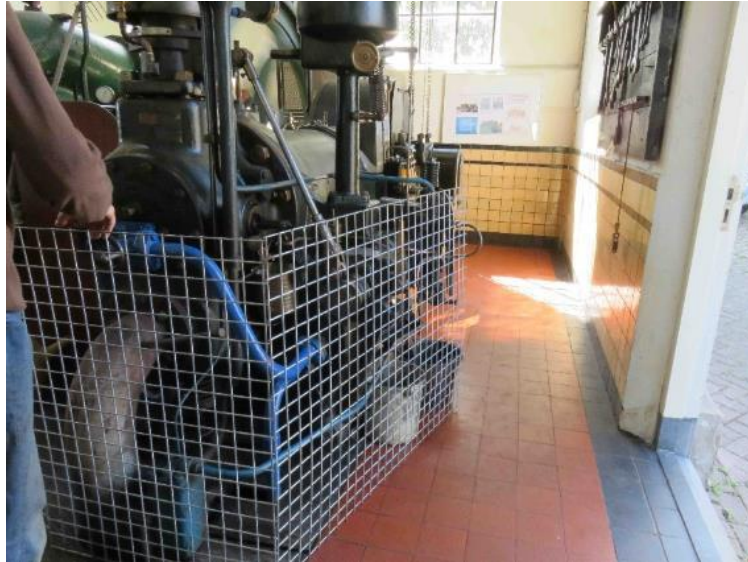
Afscherming van de hoofdmotor aan bedieningszijde tijdens bedrijf
