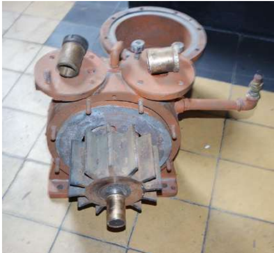
Voorbeeld vacuümpomp (Gemaal J.A. Beijerinck)
