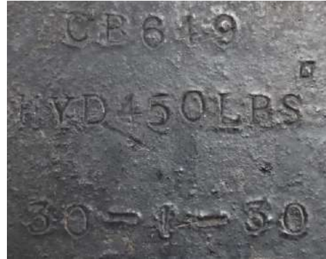
Testdrukgegevens in de romp van het drukvat
