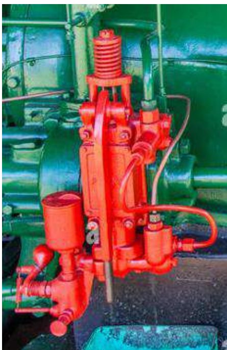
Brandstof pomp met zwengel voor ontluchten
