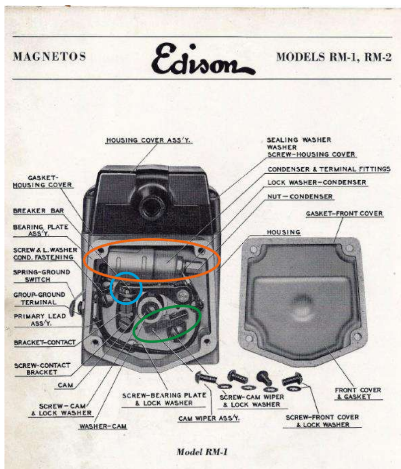
Edison Splitdorf ontstekingsinrichting voor 1-cilinder motor (frontzijde)
