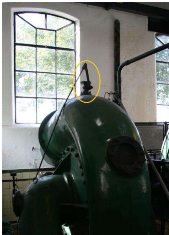
Vacuümverbreker met trekstang
