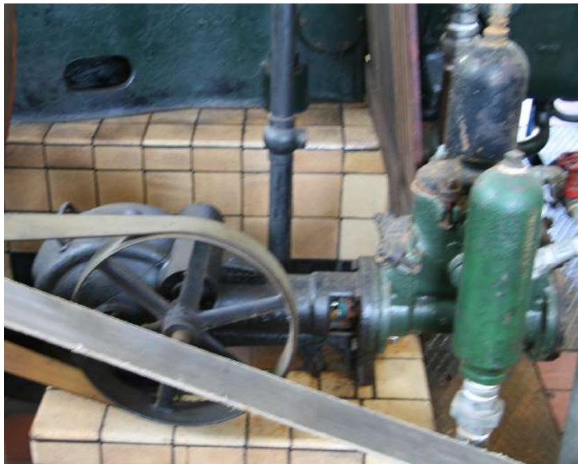
Situatie koelwaterpomp met luchthelmen
